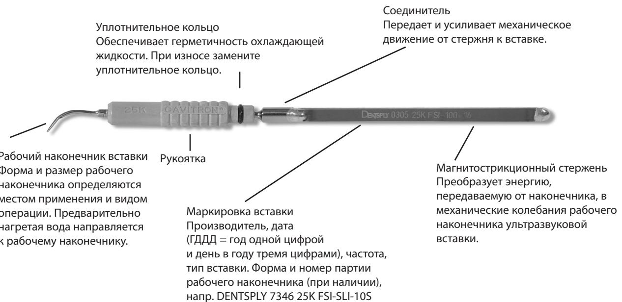
Держите наконечник вертикально. Нажмите на педаль управления до появления воды, чтобы выпустить воздух, который мог остаться в наконечнике. Перед установкой уплотнительного кольца в наконечник следует увлажнить кольцо водой, обеспечив смазку. Установите вставку на место до упора мягким нажимом с поворотом. ЗАПРЕЩАЕТСЯ ПРИЛАГАТЬ ЧРЕЗМЕРНЫЕ УСИЛИЯ.
