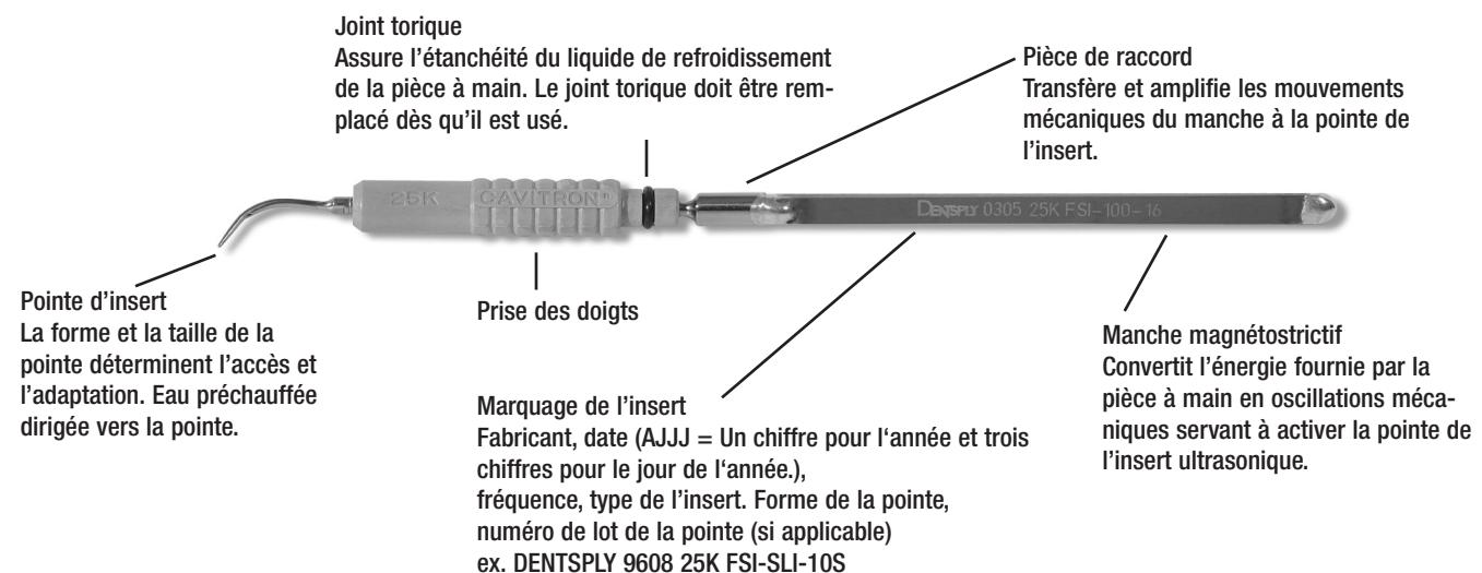
Tenez la pièce à main en position verticale. Activez la pédale de contrôle pour chasser toute bulle d'air pouvant être emprisonnée dans la pièce à main. Lubrifiez le joint torique en caoutchouc de l'insert avec de l'eau avant de le placer dans la pièce à main. Insérez complètement l'insert en tournant et en poussant doucement. NE FORCEZ PAS.
